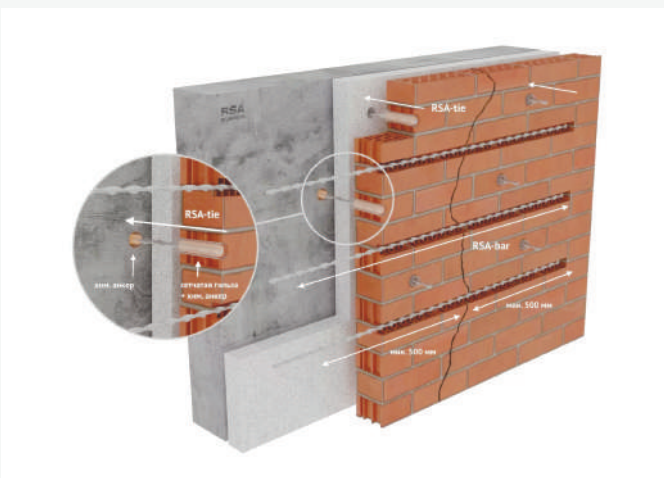
Рис. 11 Ремонт облицовочной кладки с несущим слоем из тяжелого бетона
