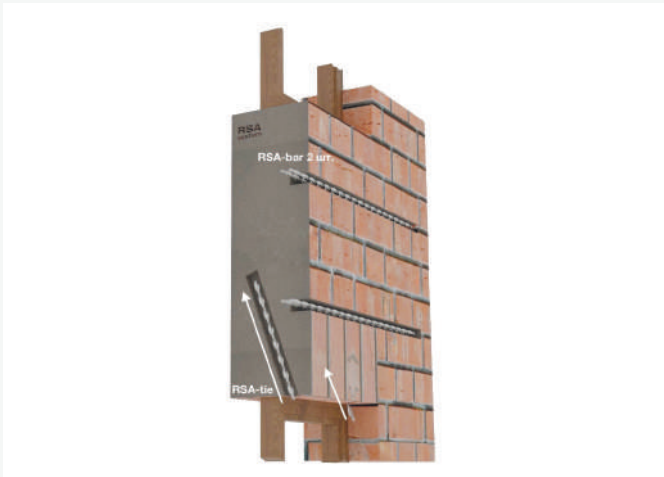
Рис. 9 Ремонт надоконной перемычки вар. 2
