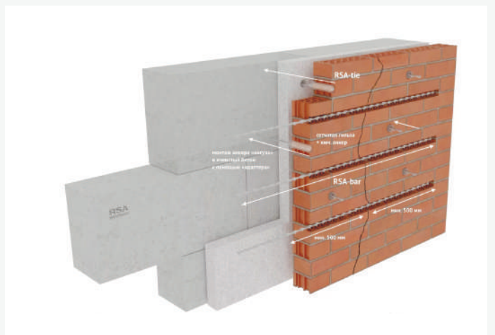
Рис. 12 Ремонт облицовочной кладки с несущим слоем из ячеистого бетона
