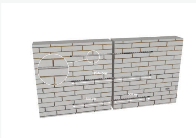
Рис. 6 Укрепление температурно-деформационного шва
