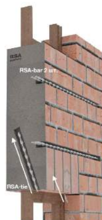
Рис. 12 Ремонт надоконной перемычки вер. 2
